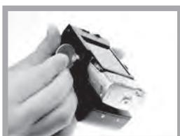
再利用硬幣正時鐘方向鎖緊，請務必確定Canon相機與模組已鎖上。
