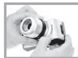
若要更換物鏡，請先按住物鏡鬆開鈕，反時鐘方向旋轉物鏡約45度，停住後不要再過度轉動，只要輕輕提起鏡頭即可完成。
