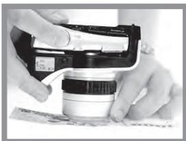
直接將接觸環貼近被攝物，輕壓整台X-LOUPE以便讓焦距在工作距離內，並半按快門，獲得正確焦距（出現綠框）後，按下快門（過程中請勿晃動）。
