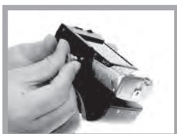
模組底部的螺絲孔正上方剛好會是相機的三腳架孔，請將所附的螺絲鎖插上。
