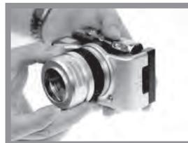
每一物鏡的鏡筒皆可逆時鐘方向旋轉取出，反之裝上。
